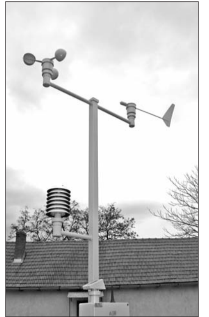
Az új eszköz segítségével többek között a szél iránya és ereje, a hőmérséklet és a csapadékállapot is mérhető.
